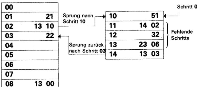
Beachten Sie, daß die ursprünglich im Schritt **02** stehende Anweisung jetzt im Schritt **10** abgespeichert ist. Damit ist im Schritt **02** Platz für einen Sprungbefehl zum Schritt **10** freigeworden. An die fehlenden Anweisungen in den Schritten **11** bis **13** ist ein weiterer Sprungbefehl angehängt, der die Programmausführung wieder ab Schritt **03** weiterführt.
