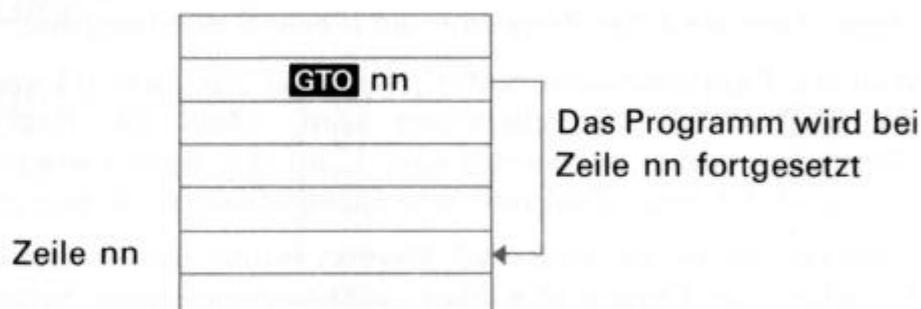
Eine **GTO**-Anweisung dieser Art wird als unbedingter Sprung bezeichnet. Der Sprungbefehl zu der angegebenen Programmspeicherzeile wird immer unbedingt ausgeführt. Später werden Sie erfahren, wie eine von einer Bedingung abhängige Anweisung in Verbindung mit der **GTO**-Anweisung zu einer bedingten Programmverzweigung führt, also einer Verzweigung, die vom Vorliegen einer bestimmten Voraussetzung abhängt.
