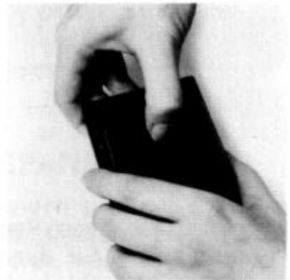
3. Drehen Sie den Rechner um und lassen Sie den Batteriesatz in Ihre Hand fallen.
