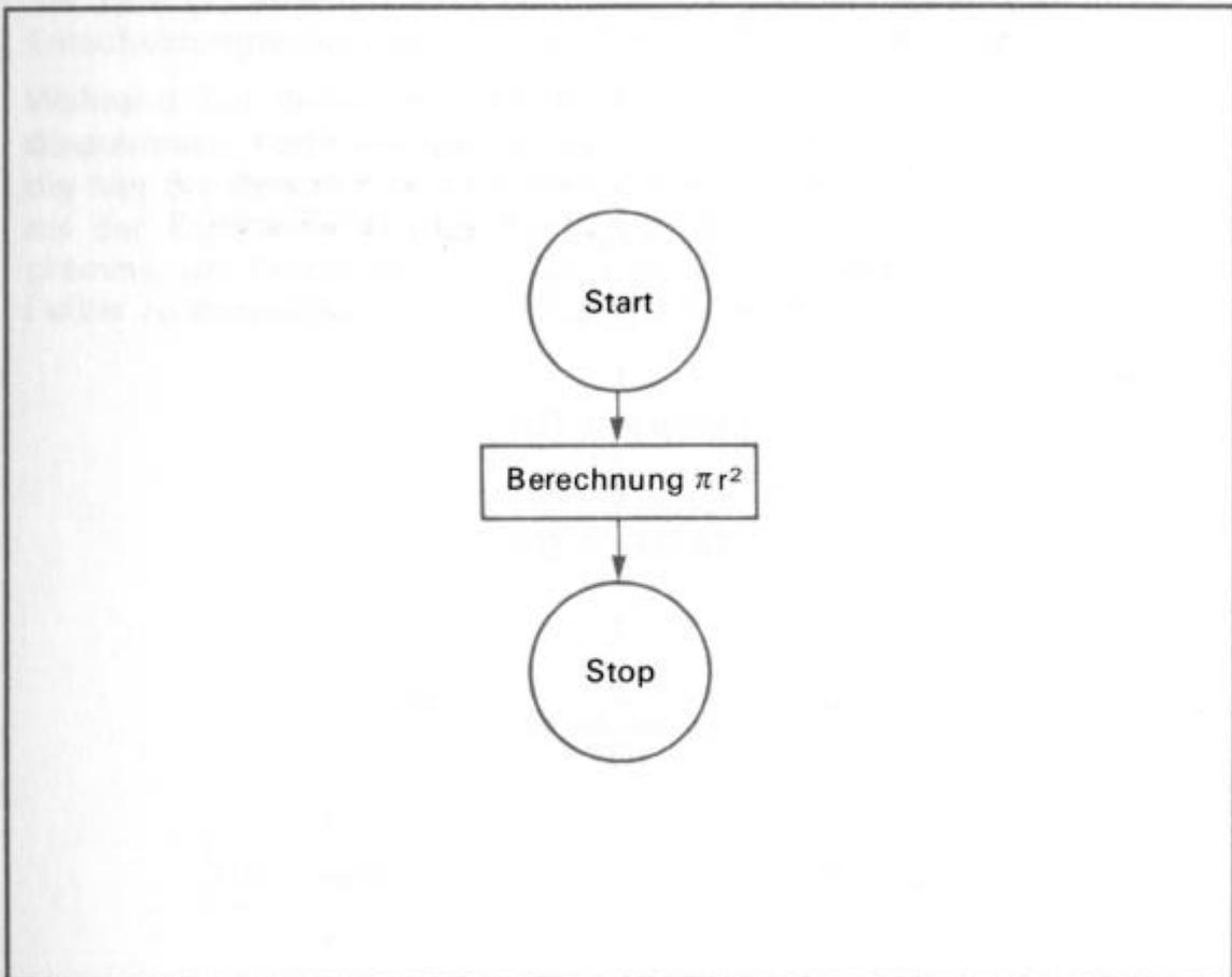
Hier werden mehrere Programmschritte durch ein Element im Flußdiagramm dargestellt. Diese Technik wird allgemein angewandt und ermöglicht dem Betrachter, sich mittels des Flußdiagramms ein Bild von dem gesamten Programm zu machen.
