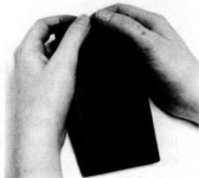
6. Drehen Sie Ihren Rechner um und schalten Sie ihn ein. Falls die Anzeige ausbleibt, prüfen Sie, ob der Batteriesatz richtig eingesetzt wurde und kontrollieren Sie die Batteriekontakte.
