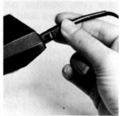
2. Drücken Sie auf den geriffelten Teil des Batteriefachdeckels (zwischen den oberen Gerätefüßen), bis der Deckel aufspringt und nach oben geschoben werden kann.
