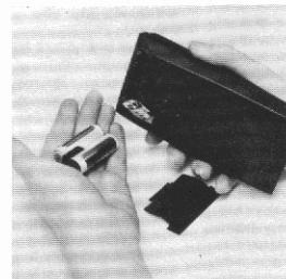
4. Setzen Sie einen neuen Batteriesatz ein.
