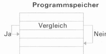
Wie Sie sehen, führt der Rechner im Anschluß an die Vergleichsoperation den nächstfolgenden Programmschritt nur dann aus, wenn die mit der Testoperation gestellte Bedingung erfüllt ist, d.h. die Antwort **Ja** lautet.
