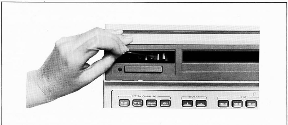
Reinigen des Magnetkopfes und des Antriebsrades
