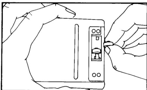
6. Schieben Sie die Abdeckung des Batteriefachs in die vorgesehene Führung des Rechnergehäuses.
