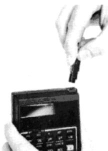
2. Pressione as presilhas da tampa da bateria conforme indicado até que ela se solte. Remova-a então.
