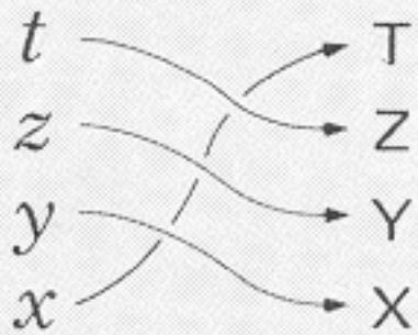
**Ejemplo:** Cargar el bloque pulsando **1** **ENTER↑**, **2** **ENTER↑**, **3** **ENTER↑**, **4** (el bloque ahora contiene  $X=4$ ,  $Y=3$ ,  $Z=2$  y  $t=1$ ). Para revisar el contenido del bloque pulsar **R↓** cuatro veces. La cuarta **R↓** devuelve el bloque a su posición original ( $X=4$ ,  $Y=3$ ,  $Z=2$  y  $t=1$ ).
