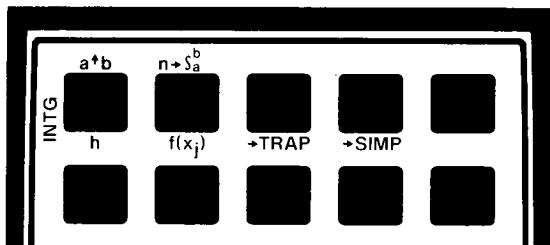
Dieses Programm leistet numerische Integration für den Fall, daß eine Funktion explizit oder nur an einer endlichen Zahl abstandsgleicher Stützstellen (diskreter Fall) definiert ist. Die Integrale expliziter Funktion werden nach der SIMPSONschen Regel bestimmt; für diskrete Fälle wird entweder nach der Trapezregel angenähert oder auch die SIMPSONsche Regel angewendet.
