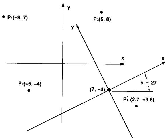
Die Punkte  $P_1$ ,  $P_2$  und  $P_3$  sollen in die äquivalenten Koordinaten des  $(x', y')$ -Systems überführt werden. Außerdem soll  $P_4$  in das  $(x, y)$ -System überführt werden. (Es werden Winkelgrade verwendet.)
