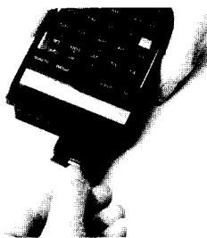
3. Stecken Sie eine Schutzkappe auf die unbelegte Anschlußbuchse.
