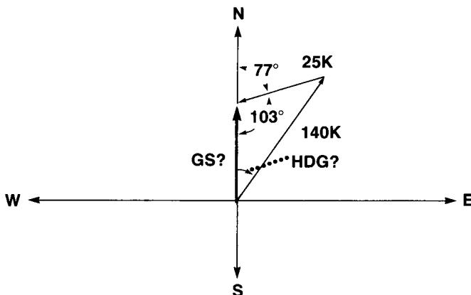
Zieht man die Windrichtung von 180° ab (man erhält dabei einen Winkel von 103°), reduziert sich das Problem auf eine S<sub>1</sub>, S<sub>2</sub>, A<sub>2</sub> Lösung.
