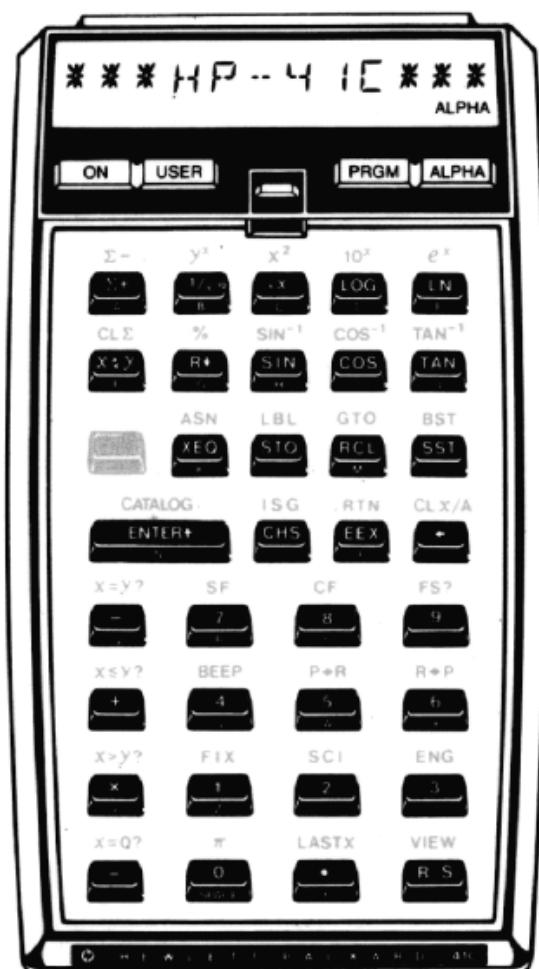
Desligue a HP-41C antes de remover ou inserir qualquer das extensões conectáveis! A mensagem **MEMORY LOST** indica que a Memória Contínua foi apagada.
