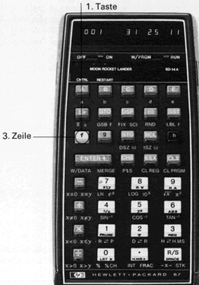
Der zweite Code, 25, bezeichnet die 5.Taste in der 2.Tastenfeldzeile; da der vorhergehende Code für die Präfixtaste **f** stand, bezeichnet der Tasten-Code 25 jetzt die Funktion **LBL**. Der letzte angezeigte Code in dieser Programmspeicherzeile ist 11; in der 1.Zeile finden Sie als 1.Taste **A**. Die vollständige Anweisung, die in Zeile 001 des Programmspeichers steht, lautet demnach **f LBL A**.
