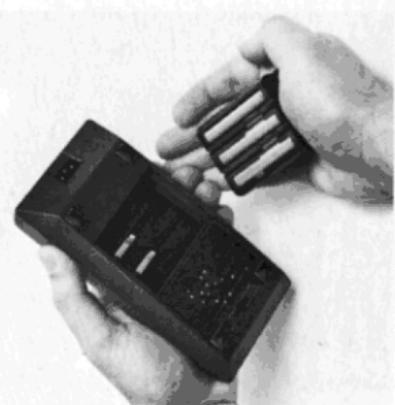
4. Kontrollieren Sie die mechanische Spannung der beiden Batteriekontakte und biegen Sie sie gegebenenfalls etwas nach oben, um einen einwandfreien Kontakt mit dem Batteriesatz zu gewährleisten.
