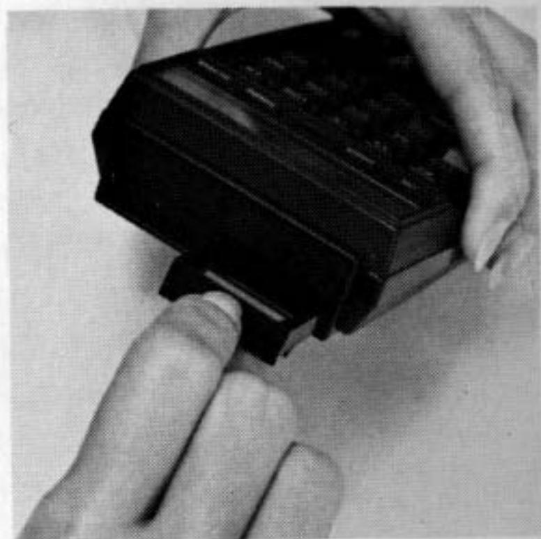
3. Führen Sie den Stecker des Kartenlesers wie abgebildet in die Anschlußbuchse 4 ein. Schieben Sie dann den Kartenleser mit leichtem Druck soweit in den Rechner ein, bis er hörbar einrastet und mit dem Rechnergehäuse verriegelt ist.
