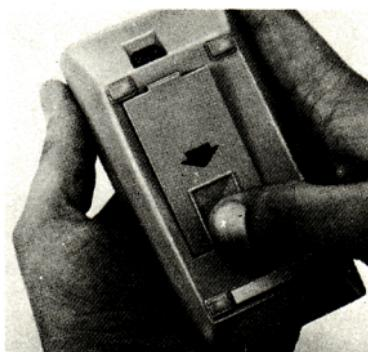
3. Introduisez une nouvelle batterie dans le sens de la flèche. Inclinez le rebord du guide de la batterie dans celui de la trappe et mettez en place une nouvelle batterie.
