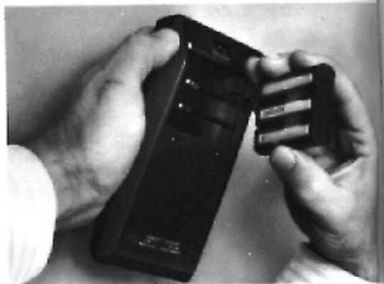
6. Batteriedeckel unter den unteren Rand des Gehäuses schieben.
