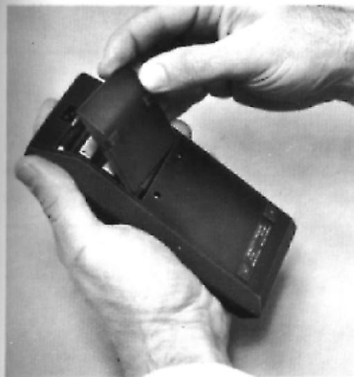
7. Deckel vorsichtig schließen und die Riegel nach außen schieben.
