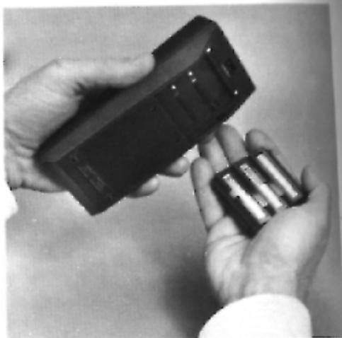
4. Kontrollieren, ob Batteriekontakte noch mechanische Spannung haben. Wenn nicht, dann etwas herausziehen. Batterie nochmals überprüfen.
