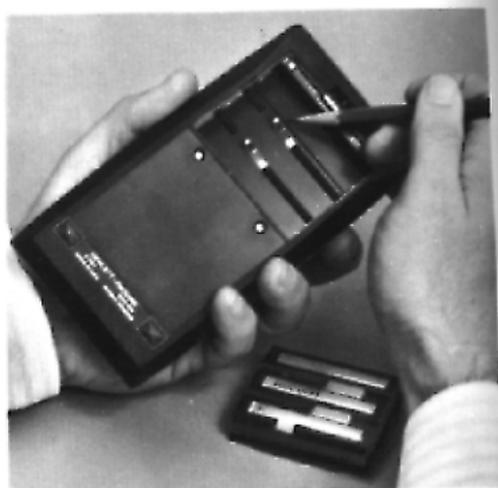
5. Batterie mit den vergoldeten Kontakten nach innen einsetzen.
