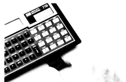
Zum Entfernen des Moduls ist das Modul mit den Fingernägeln am Griffstück auf der Vorderseite anzufassen und dann aus dem Einschubsschacht herauszuziehen. Anschließend ist der Einschubsschacht mit einer Modulattrappe zu verschließen, um die Kontakte vor Staub und sonstigen Partikeln zu schützen.
