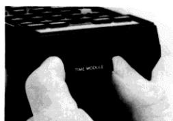
Note : A chaque enfichage du module mémoire, mettez aussitôt le calculateur sous tension. Cette opération a pour but d'initialiser le module. Si le calculateur n'est pas mis sous tension immédiatement après l'enfichage du module, ce dernier pourrait consommer une énergie de la batterie supérieure à sa valeur normale.
