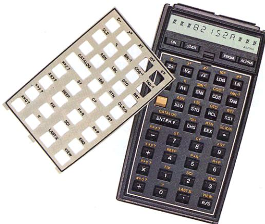
56 der am häufigsten benötigten Funktionen finden Sie unmittelbar auf dem Tastenfeld des HP-41C. Wenn Sie bevorzugt diese Funktionen verwenden, können Sie den Rechner im NORMAL-Modus einsetzen.
