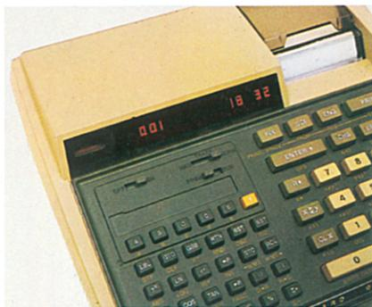
Diese Operation belegt die erste Zeile des Programmspeichers, was durch die 001 angezeigt wird. Der Tastencode 16 bezeichnet die sechste Taste in der ersten Reihe im linken Tastenblock (f). Mit dem Tastencode 32 wird die zweite Taste in der dritten Reihe des linken Tastenblocks (LOG) bezeichnet. Tasten auf der rechten Seite der Tastatur werden mit einem Minuszeichen gekennzeichnet.
