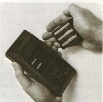
4. Kontrollieren Sie die mechanische Spannung der beiden Batteriekontakte und biegen Sie sie gegebenenfalls etwas nach oben, um einen einwandfreien Kontakt mit dem Batteriesatz zu gewährleisten.
