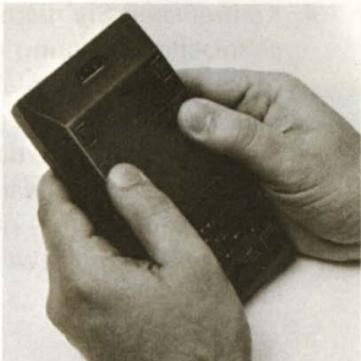
3. Drehen Sie den Rechner nach Abnehmen des Deckels um und lassen Sie den Batteriesatz herausfallen.
