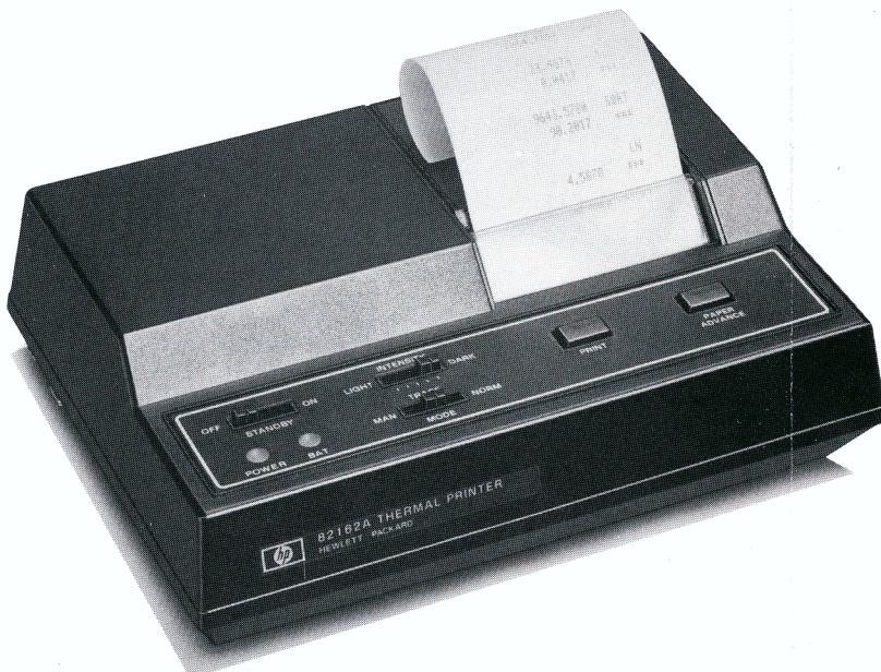
Imprimez facilement vos données, les listings de vos programmes, des codes-barres ou des graphiques avec l'imprimante/traceur thermique portable HP 82162A.
