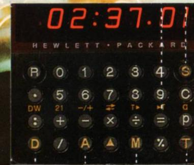
Facilement utilisable à partir du clavier – il allie les fonctions d'une horloge, d'un avertisseur sonore, un calendrier de 200 ans, une mémoire permanente, un chronographe, un compteur à rebours et un calculateur. Toutes ces fonctions sont interactives.
