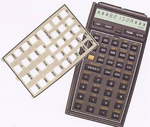
56 der am häufigsten benötigten Funktionen finden Sie unmittelbar auf dem Tastenfeld des HP-41. Wenn Sie bevorzugt diese Funktionen verwenden, können Sie den Rechner im NORMAL-Modus einsetzen.
