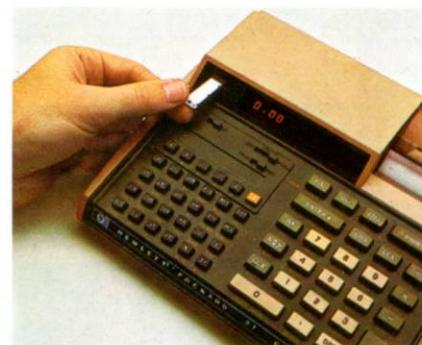
Puede almacenar datos de cualquiera de los registros dentro de la tarjeta. Puede, asimismo, cargar cualquier dato numérico en uno o varios registros. No necesita reintroducir datos para sus programas. El lector de tarjetas acepta datos antes o durante la ejecución de un programa.
