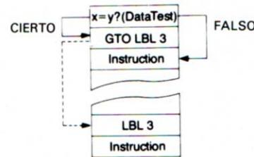
El siguiente paso es ejecutado si x = y. La ejecución del programa salta un paso si x no es igual a y.
