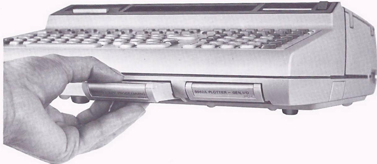
In den programmierbaren Tischrechner 9825A können gleichzeitig 4 ROMs (Festwertspeicher) eingesetzt werden, um den Befehlsvorrat des Rechners zu erweitern und um angeschlossene Geräte zu steuern.
