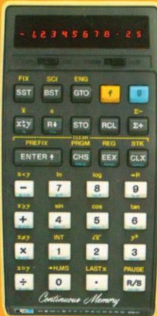
La HP-25C y su memoria continua es otro caso de novedad única de Hewlett-Packard donde se continúan las ya probadas funciones y dimensiones de la HP-25 con la ventaja de retener programas y almacenamiento de datos incluso después de apagar la calculadora.
