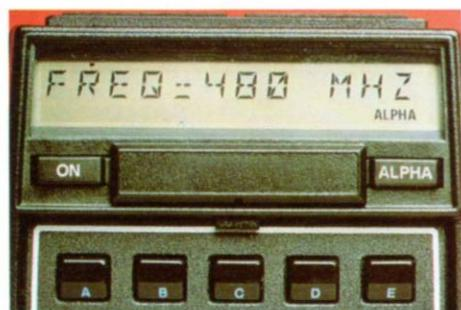
culadora. Dichos indicadores muestran en la parte inferior de la pantalla y reflejan el modo de funcionamiento y si la siguiente tecla que pulse se ejecutará o se recordará como la instrucción de un programa.
