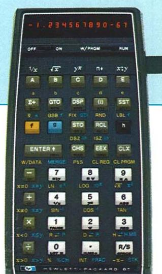
de 3 sistemas de direccionamiento simbólico, relativo o indirecto que aumenta la potencia del programa al disminuir la longitud. 20 funciones definibles, 8 funciones de test condicional, 3 niveles de subrutinas, 4 "flags"/banderas. Todas las funciones matemáticas, trigonométricas y estadísticas comúnmente utilizadas. La HP-67 y HP-97 "compatibles" son el resultado de la extensa investigación y experiencia de Hewlett-Packard en este campo. Ambas calculadoras están soportadas por un conjunto de
